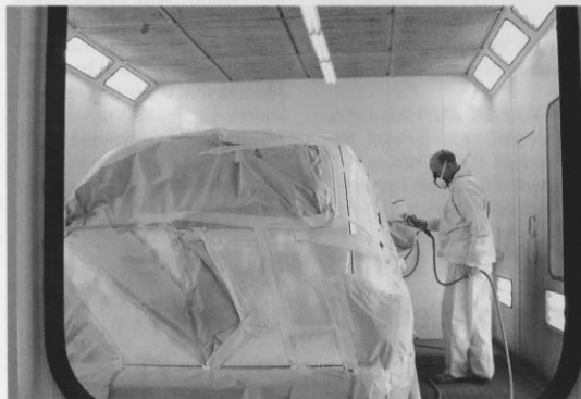
⊖ Vier, vijf lagen onder de felle, warme lampen. Tijdens het droogproces loopt de temperatuur in de cabine bij Metalak op tot onaangename waarden.
